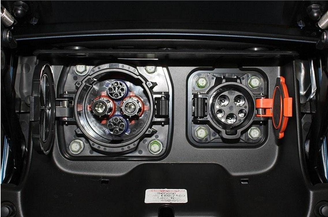
**Figura 3.** Conectores CHAdeMO y SAE J1772 (Tipo 1) en un Nissan Leaf
