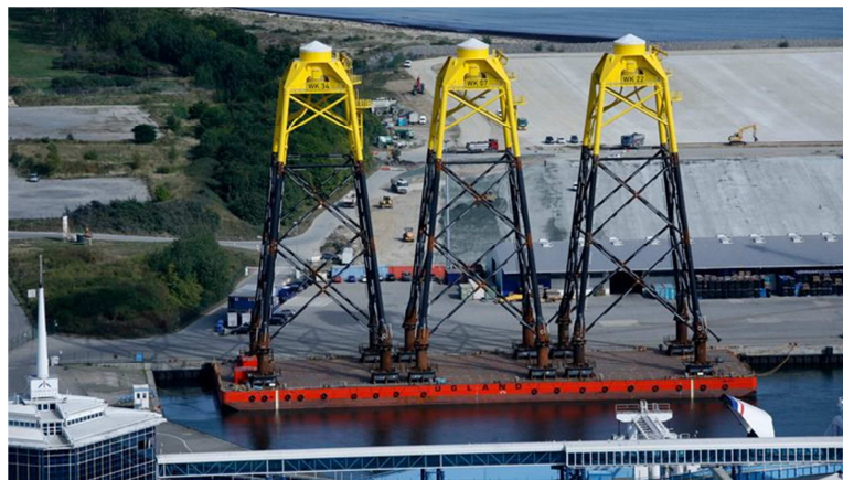
Figura 16: Plataformas Jack celosía de cuatro patas
