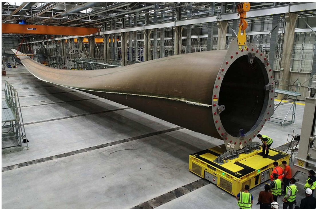
Figura 11. Pala LM 107.0 P de 107 metros en la planta de fabricación de Cherbourg (Francia)
