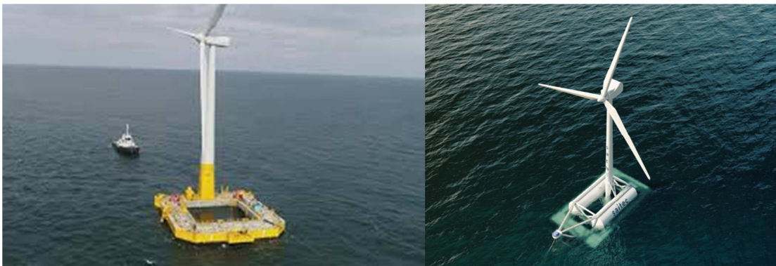
Figura 21. Aerogenerador flotante con plataforma FLOATGEN desarrollada por IDEOL. (Izda) y plataforma estabilizada tipo SATH desarrollada por SAITEC (Derch)
