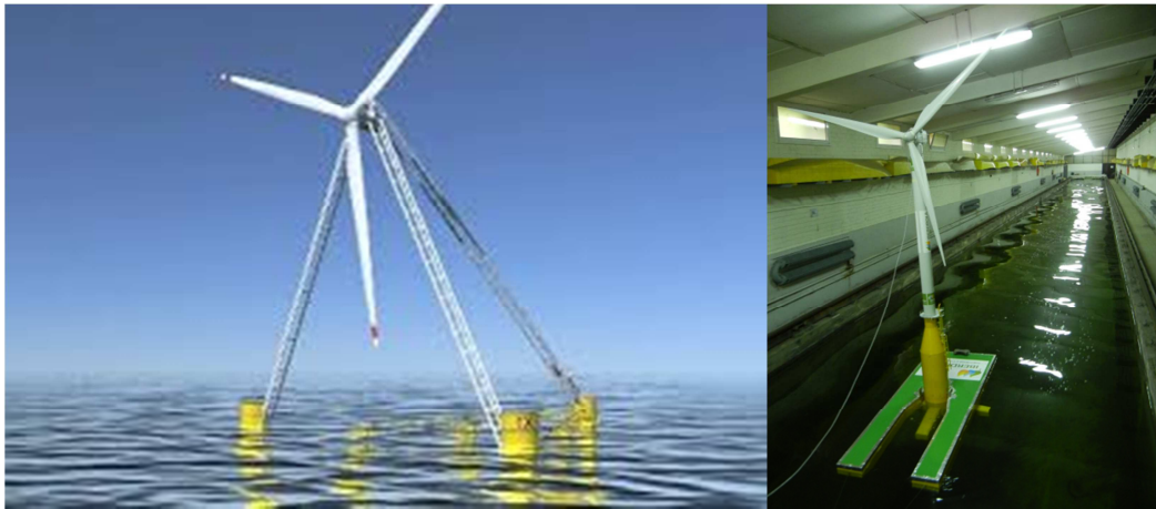
Figura 20. Simulación del prototipo de X1 Wind (Irda). A la derecha ensayos en canal del prototipo a escala de la TLP desarrollada por Iberdrola.
