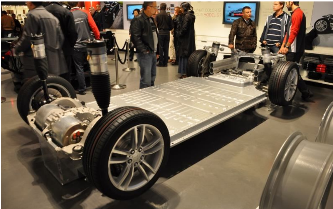
Figura 6. Chasis de un vehículo eléctrico Tesla con la batería integrada.
