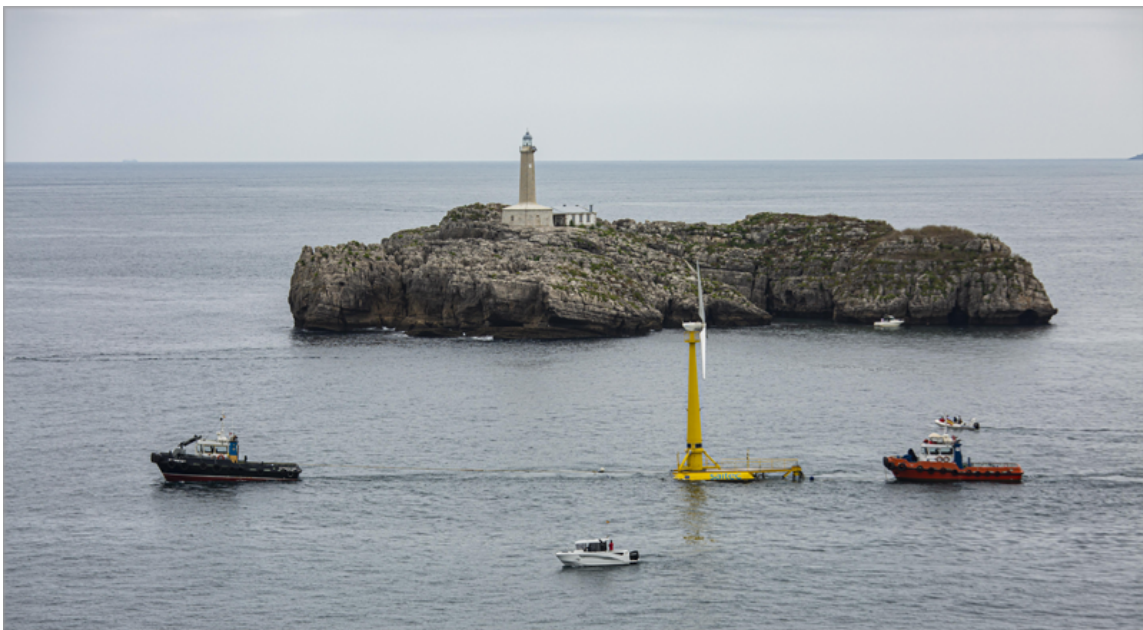
Figura 19. Plataforma Blue SATH con aerogenerador de 30 kW remolcada hasta su posición de ensayo en la bahía de Santander (España).
