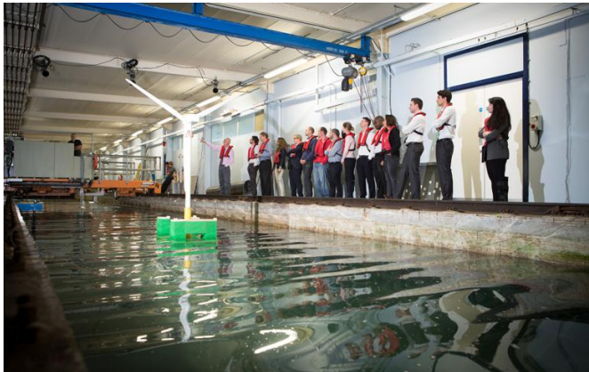
Figura 16. Ensayo del prototipo a escala de la plataforma TLPWind en el Kelvin Hydrodynamics Laboratory at the University of Strathclyde
