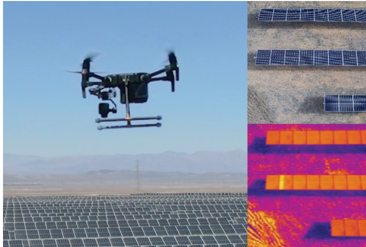
Inspecciones termográficas de centrales solares FV con drones
