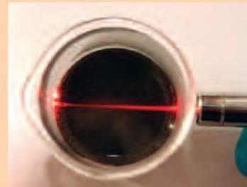
Haz incidir un haz láser (por ejemplo, el de un puntero) sobre la disolución.
