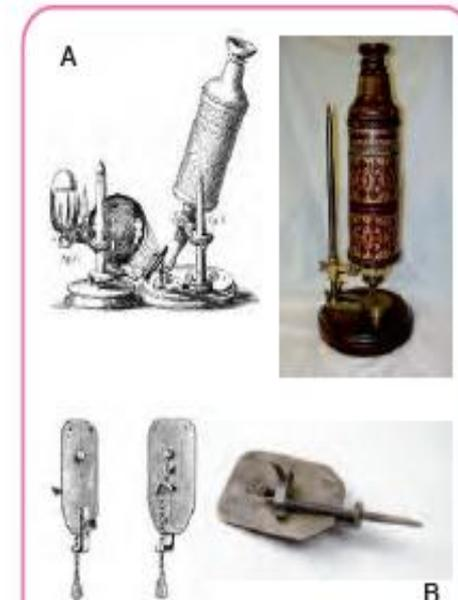
FIGURA 5.1 Los primeros microscopios. Microscopio de Robert Hooke (A) y Antonie van Leeuwenhoek (B). En cada uno de ellos se muestra un dibujo de la época (ambos de la segunda mitad del S. XVII) en el que se distinguen sus partes, y una fotografía de los que han llegado en mejor estado hasta la actualidad.
